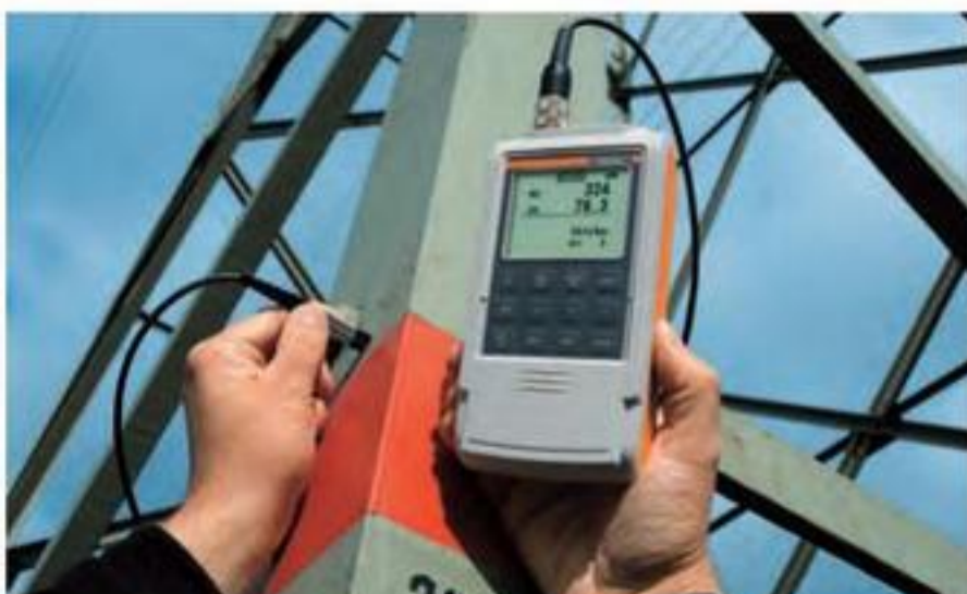
使用DUAL SCOPE® FMP40以及FD10两用探头在室外进行测量。
