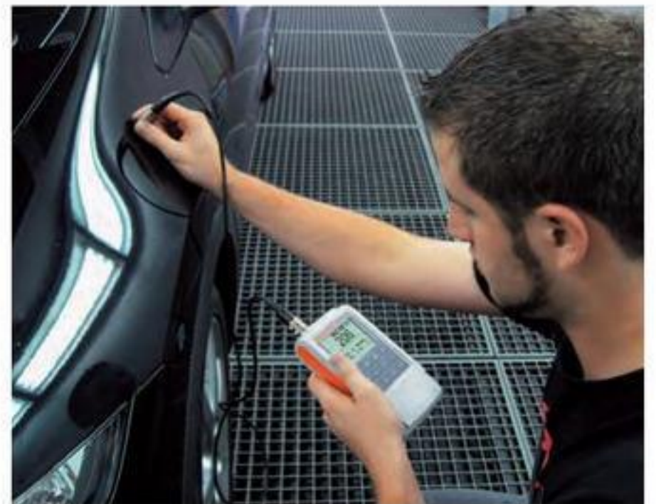
使用FD10探头测量油漆的厚度。
