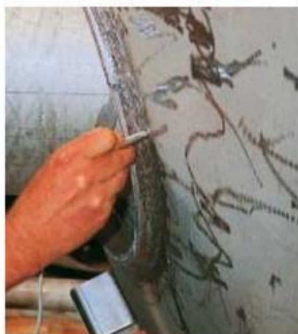
图2: 测量焊缝处的铁素体含量
